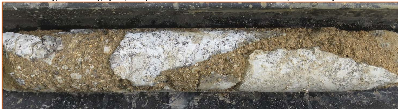
Obrázek č. 7: Výplň zdiva – sypký a opadavý materiál charakteru stmeleného hlinitého písku s drobným šterkem
